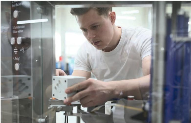
Sensorik zur Stückzahlmessung in einer 3D-gedruckten Box
